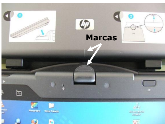
Marcas para colocar
