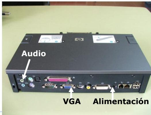
Conexión VGA, alimentación y sonido. Vista posterior
