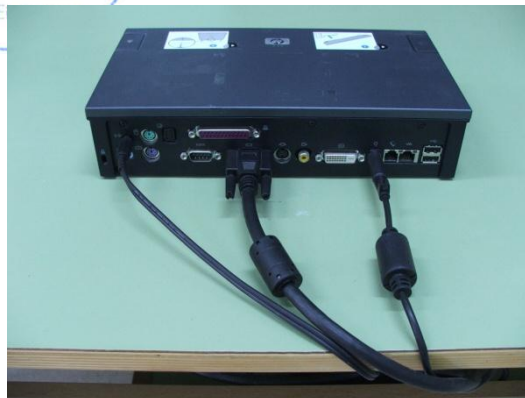
Conexión VGA, alimentación y sonido
