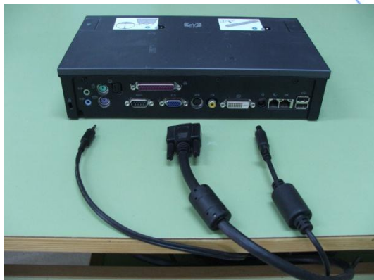
Conexión VGA, alimentación y sonido
